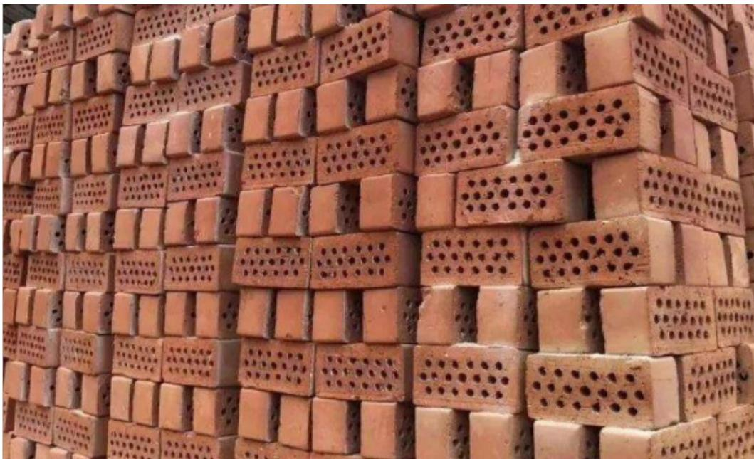
多孔砖兼具粘土砖和砼小砌块的特点，外形特征属于烧结多孔砖，材料与砼小砌块类同，符合砖砌体施工习惯，各项物理、力学和砌体性能均可具备烧结粘土砖的条件。其使用范围、设计方法、施工和工程验收等可参照现行砌体标准，可直接替代烧结粘土砖用于各类承重、保温承重和框架填充等不同建筑墙体结构中，具有普遍的推广应用前景。该产品的应用，将有助于减少和杜绝烧结粘土砖的生产使用，对于改善环境，保护土地资源和推进墙体材料革新与建筑节能，以及“禁实”工作的深入开展具有十分重要的社会和经济意义。石狮混凝土多孔砖批发价格烧结多孔砖孔洞率超过25%，孔尺寸小而多，烧结空心砖孔洞率大于35%，孔尺寸大而少。
