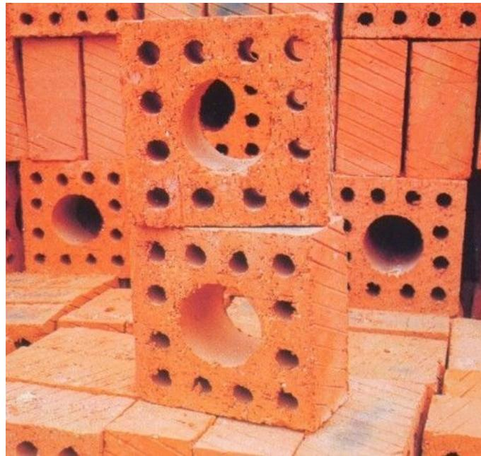
砌体强度分析：原因分析，1. 生产品混凝土多孔砖强度低，不符合设计要求，多孔砖有断裂或缺棱掉角现象。2. 砂浆配合比不当，和易性差，砌体冬期受冻，造成砂浆强度不够。3. 混凝土多孔砖排列不合理，组砌混乱，上下皮搭接长度不够，纵横墙没有有效搭接。4. 墙体随意留洞剔槽，严重削弱墙体受力面积，增大偏心距，影响墙体承载能力。5. 砌体灰缝不饱满。预防措施，1. 加强该砖质量检查，不符合要求的不得用于承重部位。对于裂纹延伸累计长度 $>20\text{mm}$ 的多孔砖严禁用于承重砌体。2. 砂浆配合比严格按重量计量，随拌随用。3. 施工前应对该砖进行预排，绘制多孔砖砌块排列图，制作皮数杆，并做好交底和过程检查，保证合理组砌和正确留置洞槽及预埋件。4. 对墙体平整度和垂直度、灰缝厚度和饱满度随砌随查。并及时复核砌体轴线及标高偏差。5. 严格按照冬期施工方案落实冬期施工措施。
